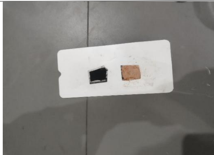
Gambar 5. Kaca di kanan merupakan elektrode kerja, dan kaca di kiri merupakan elektrode lawan.
